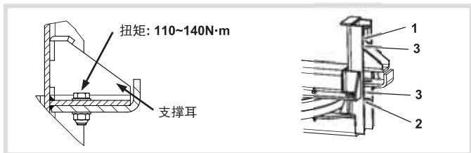
连接支撑块和轴提升支撑耳所需的零件（两端所需数量）：
